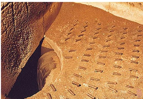
**Рис 4: Решётка кипящего слоя с направляющими соплами в районе бокового выпуска полукокса**
